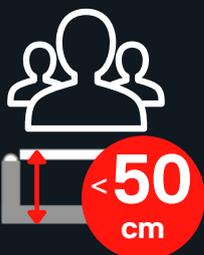
**La seguridad total de la puerta es obligatoria:** Si el espacio entre la puerta completamente abierta y la pared/objeto adyacente es  $< 50\text{cm}$  o si las puertas se abren a una zona de tráfico transversal intenso.
