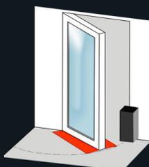
**Posición de la zona de seguridad:** Para garantizar el cumplimiento de la norma EN 16005, una caja de prueba aprobada debe ser detectada en el área protegida, como se ilustra en el Anexo C.
