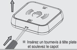
2 Installez les piles et allumez l'AerWave. Enregistrez l'émetteur avec le récepteur à l'aide du bouton Enregistrer/Supprimer (voir section 4).
