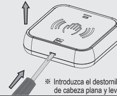
\* Introduzca el destornillador de cabeza plana y levante la cubierta.
