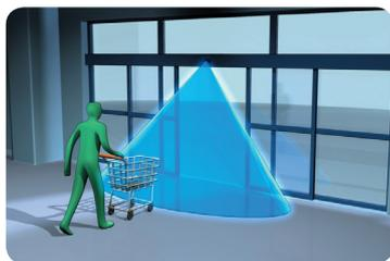
Détecteur robuste et élégant pour portes battantes et coulissantes, pouvant être monté jusqu'à une hauteur de 4 m
