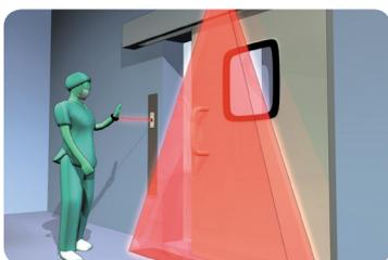
Berührungsfreier Türaktivierungsschalter mit Mikrowellentechnologie für den Einsatz in Anlagen, in denen Hygiene von höchster Bedeutung ist, wie z. B. in Reinräumen, in der Lebensmittelverarbeitung und in der chemischen Industrie
