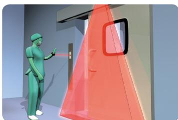
La commande d'activation de portes à technologie hyperfréquence a été conçue pour des installations dans lesquelles l'hygiène est d'une importance primordiale telles que les salles blanches, ou pour les applications de transformation agro-alimentaires et l'industrie chimique
